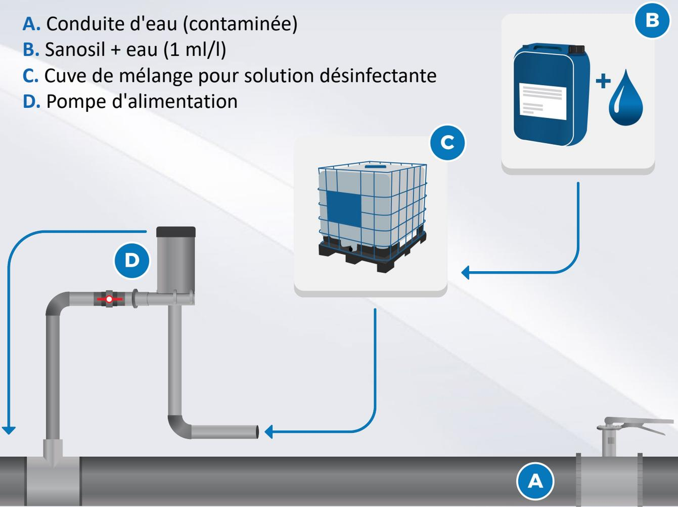
Mélanger la solution désinfectante et utiliser une pompe pour l'injecter dans le réseau de canalisations contaminé.
