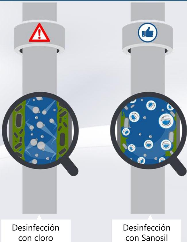
En caso de fuerte crecimiento de biopelículas, la desinfección con cloro es prácticamente inútil, ya que las biopelículas no se eliminan de forma fiable.
