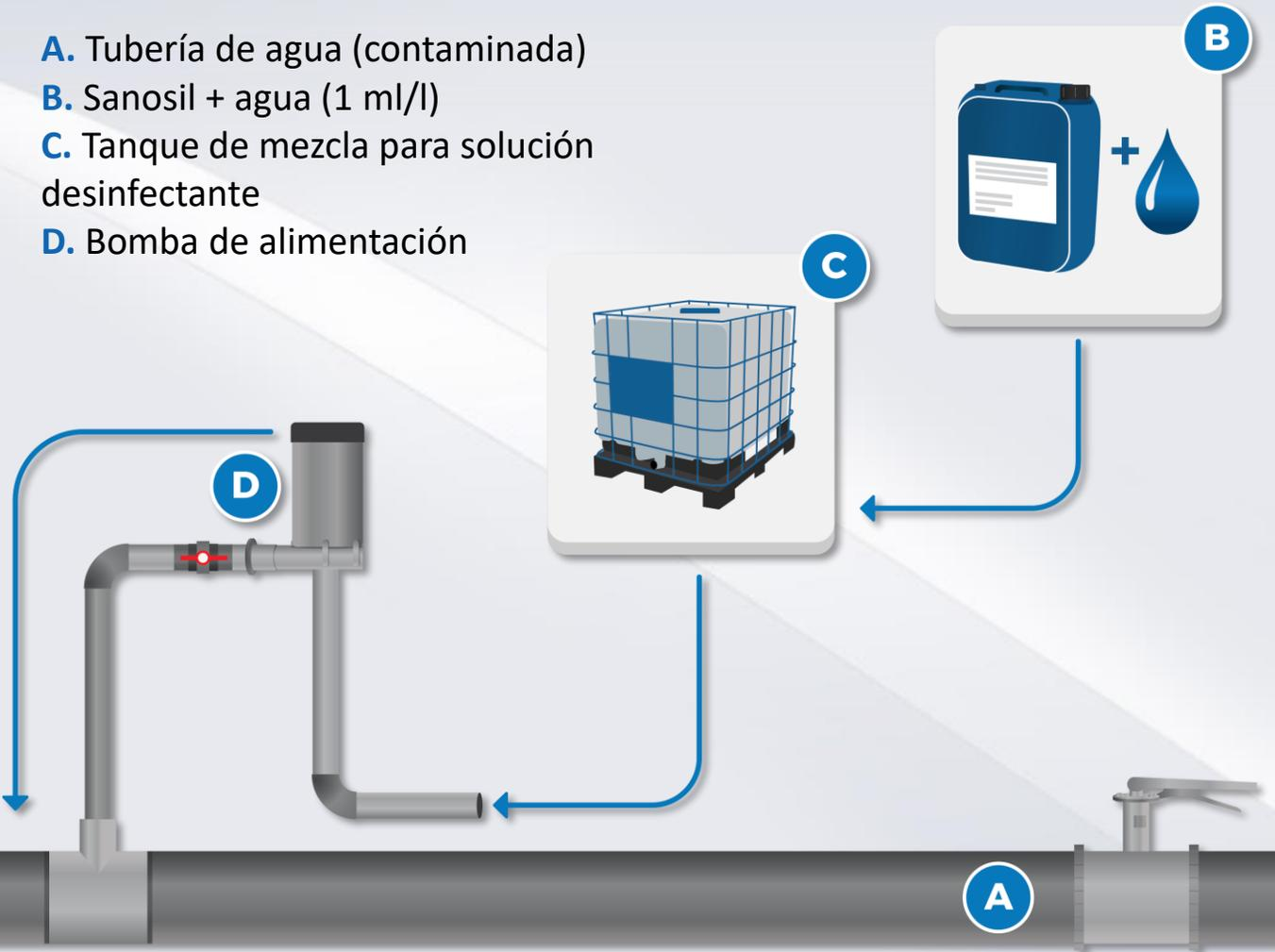
Mezclar la solución desinfectante y, con ayuda de una bomba, introducirla en el sistema de tuberías contaminado.
