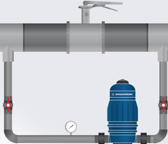
Con dispositivo de dosificación Dosatron y derivación. 0,1 %
