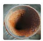
El agua de refrigeración contenida en los circuitos cerrados no se evapora activamente. Solo se utiliza para la transferencia térmica. Para ello se usa generalmente agua descalcificada, que no genera sedimentos de cal o minerales, pero en cambio es muy **corrosiva.** Por eso, los **inhibidores de corrosión** de los acondicionadores para circuitos cerrados de refrigeración tienen requisitos especiales de protección anticorrosiva.
