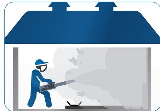
3. Eine 15% Sanosil Super 25 Lösung anmischen und zusammen mit etwas Nebelhilfsstoff in das Nebelgerät füllen. Alle Türen und Fenster schliessen und Raum mit Nebel füllen. Dosierung ca. 10-15 ml Lösung pro m<sup>3</sup>.
